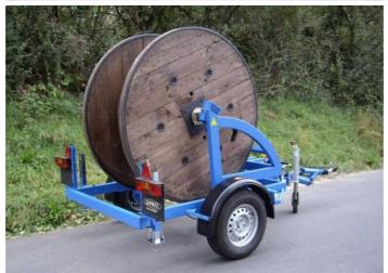
En position route, le support est verrouillé mécaniquement et le touret est prêt à être déroulé.
