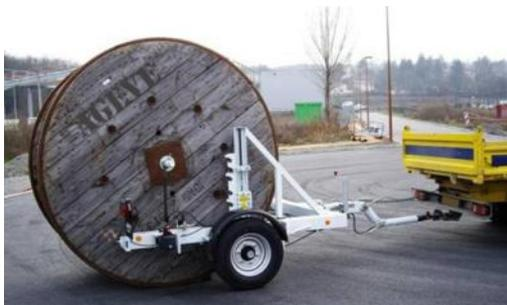
Emanation directe de la S 1500, la remorque dérouleuse S 2000 permet le chargement rapide d'un touret jusqu'au Ø 2,60 m (IBM) par l'action de vérins de poussée simple effet, alimentés par une pompe manuelle. Une vanne trois voies répartit le flux d'huile simultanément dans les deux vérins ou alternativement sur l'un ou l'autre, permettant d'obtenir l'horizontalité de l'axe du touret, même si le sol sur lequel reposent les roues de la remorque présente une importante différence de niveau.
