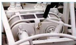
**Cabestan hydraulique à 2 moteurs Danfoss**
